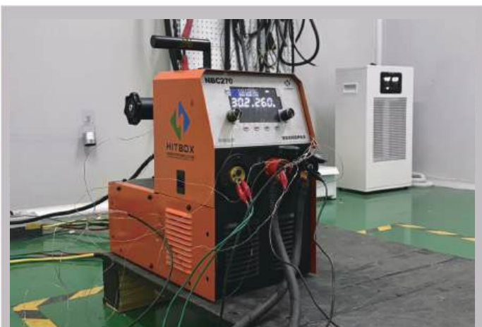
3. 满载连续工作温升测试，散热高效，长时间焊接不发烫。
