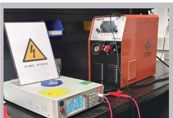
5. 严苛电气耐压测试，强化绝缘性能，杜绝漏电隐患。
